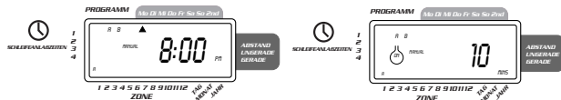
ABBILDUNG 11: Halbautomatische Bewässerung für Stationen, die für A und B-Programme bestimmt sind, alle Stationen
