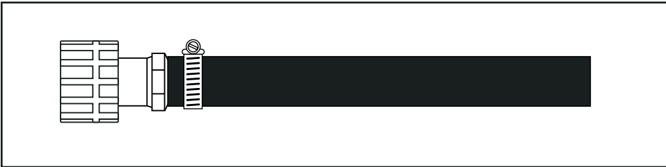
Ilustración 2: Tubo Poly-Pipe conectado al adaptador con una abrazadera
