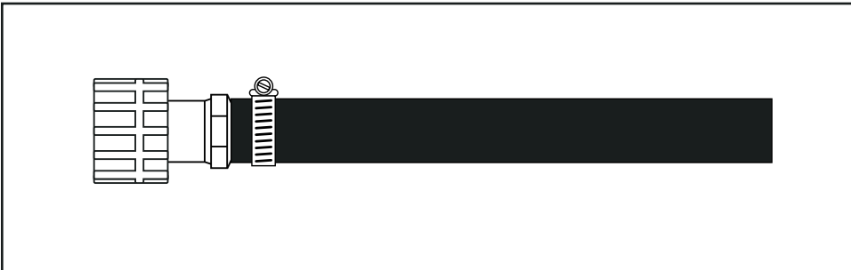
Abbildung 2: Multi-Rohr-Anschluss an Multi-Verbinder mit Schlauchklemme
