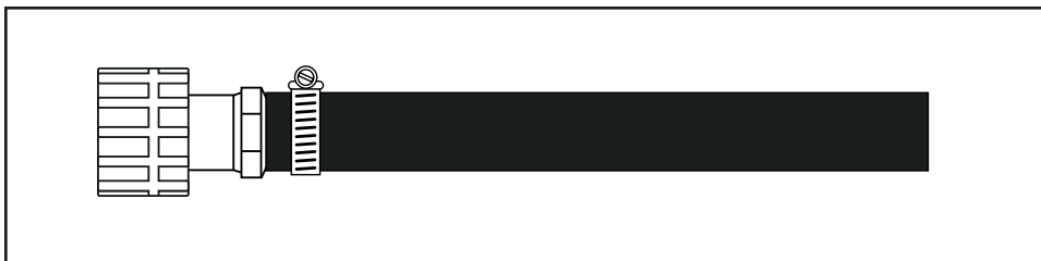
Figure 2: Tuyau Poly connecté à l'adaptateur Poly par collier de serrage
