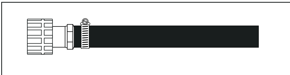
Figura 2: Tubo in polietilene collegato all'adattatore in polietilene con clamp
