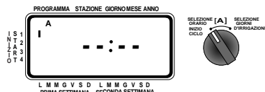
FIGURA 5: Display a cristalli liquidi con l'orario d'inizio
